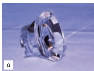
Фото 4. Примеры изделий оптического назначения, изготавливаемых на литьевой машине MacroPower E: а – линза; б – осветительное оптическое устройство для зданий (фото 1–6: Wittmann Battenfeld)
