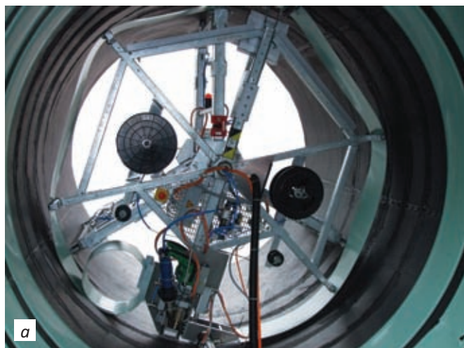
Машина WEGENER IWS для сварки по внутреннему радиусу (а) и ее сварочный узел (б) (все фото: WEGENER)
