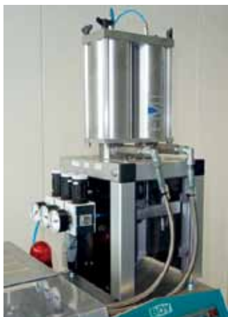
Фото 2. Смесительный насос компании ЕМТ для работы с упаковками жидкого силиконового каучука, имеющими небольшой объем
