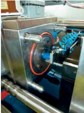
Фото 4. Устройство для извлечения готовых изделий
