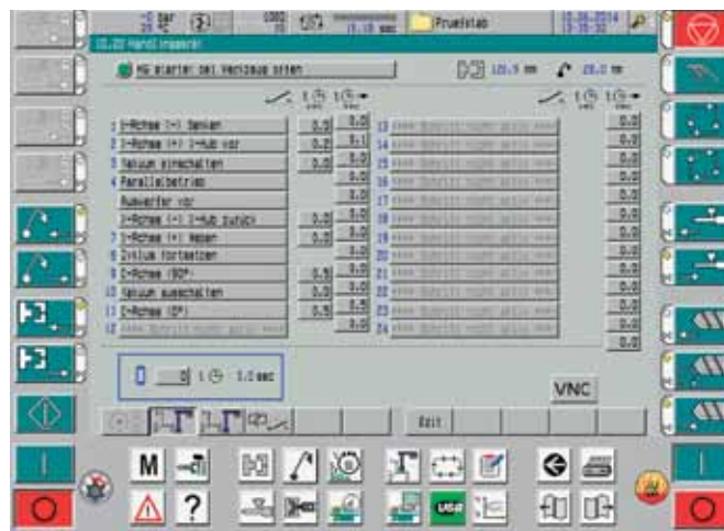
Фото 3. Панель интегрированного модуля управления манипуляторами (в настоящее время обслуживание панели управления можно проводить и на русском языке. – Прим. ред.)
