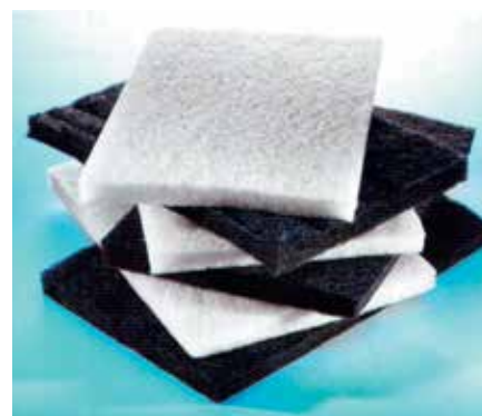
Фото 2. Легкие абсорбирующие нетканые материалы серии sowosorb могут быть использованы для изготовления большинства деталей автомобиля, от которых требуется звукоизолирующая способность [3, с. 41]
