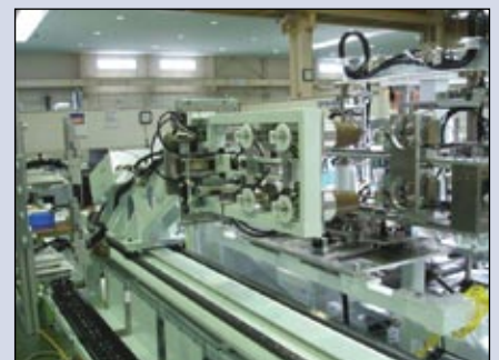
Новый робототехнический комплекс компании Star Automation для литья под давлением по технологии IML
