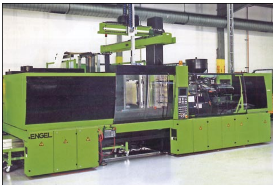
Рис. 4. Горизонтальная литьевая машина марки ENGEL VICTORY 1350/350 Tecomelt с линейным робототехническим устройством ENGEL ERC 63/1-C (источник: Engel)
