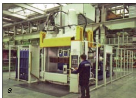
Рис. 12. Производственный модуль на базе ТПА марки ENGEL DUO 7050/1700 Tecomelt: 1 - гибкий робот для манипуляций с текстильными заготовками и готовыми деталями; 2 - устройство для облегчения монтажа и демонтажа больших пресс-форм; 3 - аккумулятор давления для увеличения скорости литья; 4 - периферийная станция для своевременной подготовки и подачи текстильных заготовок и удаления готовых деталей; 5 - станция предварительного подогрева текстильных заготовок (источник: Engel)
