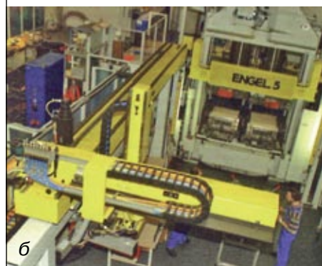
Рис. 11. Установки ENGEL Tecomelt для экструзионно-прессового формования композиционных деталей с большой площадью поверхности: а - ENGEL Tecomelt 2500/2500/800 VR; б - установка с робототехническими периферийными устройствами (источник: Engel)
