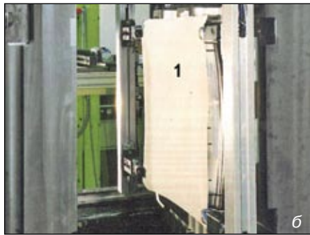
Рис. 6. Робототехнические устройства для подачи в форму тканых заготовок и удаления готовых деталей: а - подача ткани 1 и удаление детали 2; б - подача ткани 1 из рулона (источник: Engel)
