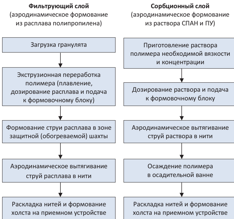
Рис. 1. Принципиальные схемы технологических процессов аэродинамического формования нетканых материалов из полимерных расплавов и растворов, предназначенных для изготовления фильтрующего и сорбирующего слоев КФСМ соответственно
