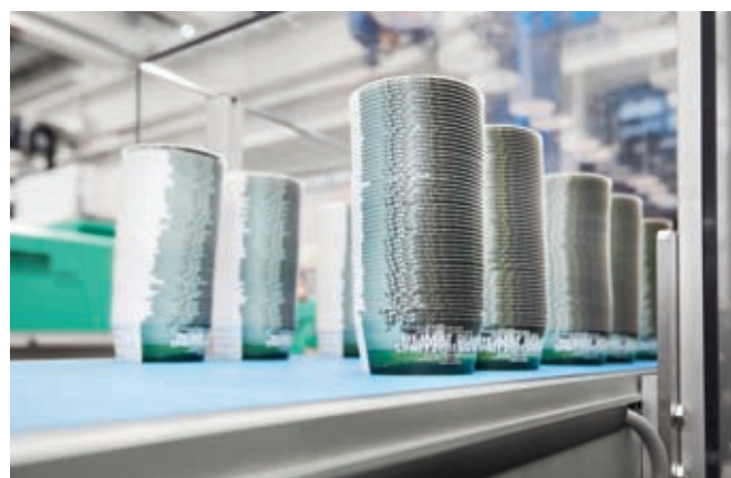
Фото 4. Штабелированные этикетированные стаканы из полипропилена, изготовленные по четыре штуки за время цикла менее чем 2 с
