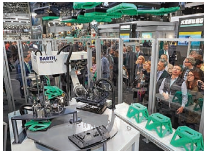
Фото 2. Станция автоматизированной сборки складных табуретов
