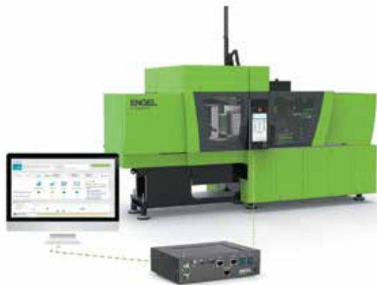
Рис. 1. Система-помощник iQ process observer компании ENGEL, которая в числе других будет установлена на литьевой машине на выставке «К-2019», откроет новые возможности «умной» поддержки переработчика. На всех стадиях процесса литья под давлением программное обеспечение будет одновременно и непрерывно отслеживать и анализировать несколько сотен параметров процесса (все рисунки: ENGEL)
