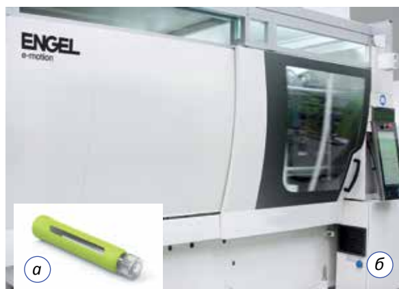
Рис. 2. Толстостенная корпусная деталь медицинского назначения (а) требует значительно более короткого времени цикла при ее двухкомпонентном литье, которое на выставке «К-2019» будет «вживую» проводиться на полностью электрической машине e-motion 310H/170W/160 combi в исполнении для чистого помещения (б)
