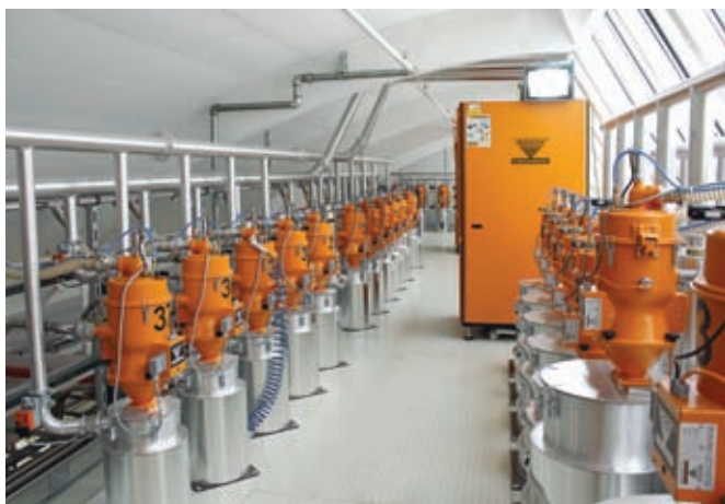
Фото 2. Платформа с размещенными на ней тремя большими сушилками воздуха типа СКТ для снабжения сухим воздухом 38 сушильных бункеров производительностью до 1600 м 3 /ч
