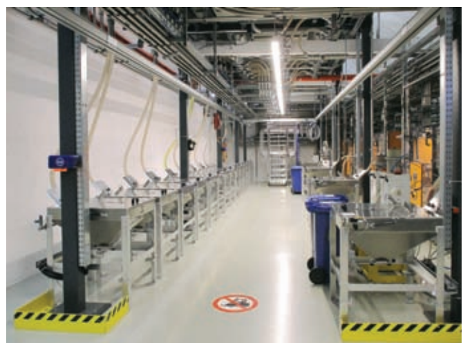
Фото 5. Перед загрузкой гранулята в один из 26 контейнеров проводится сканирование имеющегося на них штрихкода, и контейнер открывается только в случае совпадения данных по материалу
