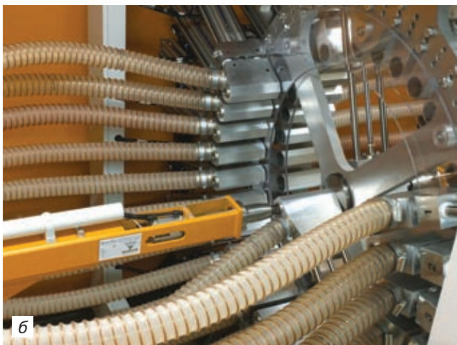
Фото 4. Каждый из 4 навигаторов, представленный на данном фото на удалении (а) и крупным планом (б), имеет в среднем по 32 входа, гарантированно обеспечивая каждого потребителя подготовленным полимерным материалом
