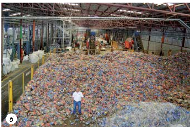
Фото 1. Современные концепции рециклинга пластмасс успешно реализуются по всему миру: а – ежедневно 30 грузовых автомобилей привозят смешанные отходы упаковки на завод компании Hündgen (Германия) для их последующей сортировки и переработки в высококачественный регранулят (фото: K-PROFI); б – сегодня компания Invema в Гондурасе перерабатывает в месяц более 2 тыс. т ПЭТ-бутылок в регранулят или пленку, мало отличающиеся по качеству от первичного материала (фото: Invema)
