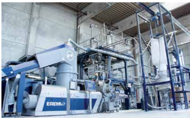
Фото 6. Компаундирующая линия компании EREMA, установленная на заводе Walter Plastics в г. Гунскирхене (Австрия), успешно производит регрануляты различных полимерных материалов (фото: EREMA)
