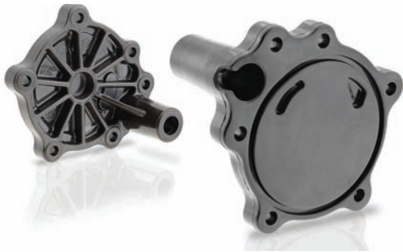
Фото 1. Пластиковая крышка вакуумного насоса должна иметь абсолютно плоскую внешнюю поверхность (справа), поэтому главное требование здесь заключается в том, чтобы на ней не отражалась сильно выраженная ребристая структура с обратной стороны крышки из-за большой усадки материала в местах ребер (слева), как это было бы в случае термопластов. Эту задачу можно без проблем решить, используя для изготовления крышки фенолоформальдегидный реактопласт (все иллюстрации: KraussMaffei)
