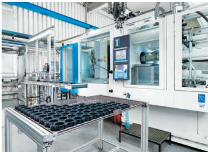
Фото 2. С 2014 г. производство высокоточных регулировочных колец масляного насоса с допуском всего лишь 10 мкм на исполнительные размеры, изготавливаемых на заводе Baumgarten из наполненного фенолформальдегидного реактопласта, ведется на литьевой машине CX 200 в непрерывном трехсменном режиме работы
