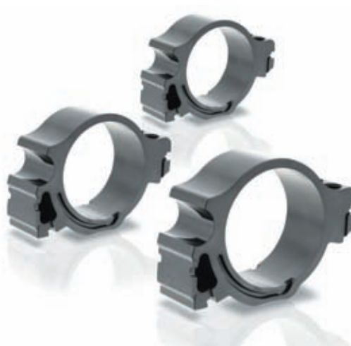
Фото 2. С 2014 г. производство высокоточных регулировочных колец масляного насоса с допуском всего лишь 10 мкм на исполнительные размеры, изготавливаемых на заводе Baumgarten из наполненного фенолформальдегидного реактопласта, ведется на литьевой машине CX 200 в непрерывном трехсменном режиме работы
