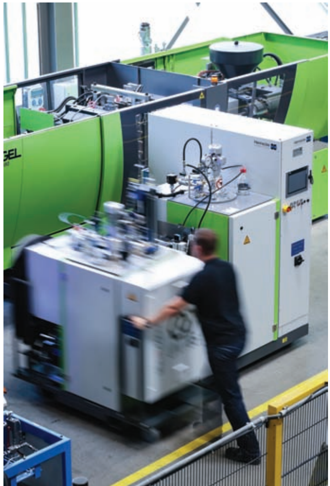
Фото 4. Цветовой модуль Multi-Connect сконструирован в форме мобильного устройства и подсоединяется к изоцианатному модулю с управлением через него (фото: Hennecke)
