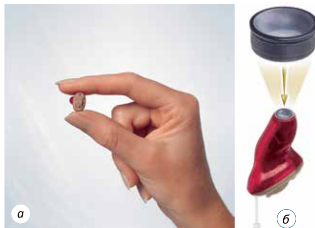
Рис. 7. Слуховой аппарат (а) и схема монтажа его мембранного устройства для защиты его и ушной серы от воды и загрязнений (б)
