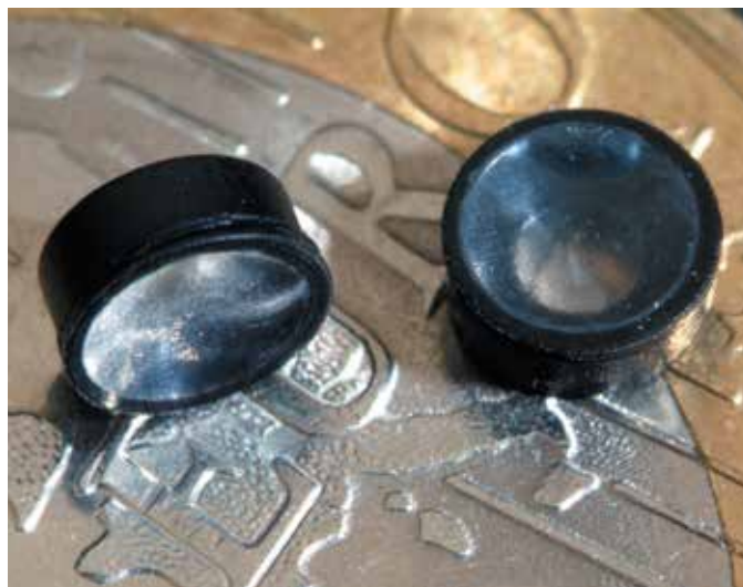
Миниатюрные акустические мембранные устройства, изготовленные с применением лазерной сварки и готовые к монтажу в слуховой аппарат Phonak
