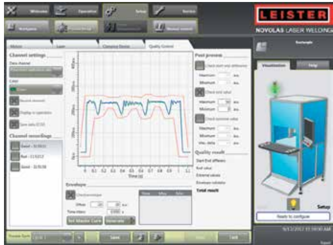
Рис. 5. Характерная термограмма процесса контурной лазерной сварки с фактической температурной кривой (синего цвета) и контрольными кривыми (красного цвета) на дисплее пульта управления сварочной установкой модели NOVOLAS (пояснения – в тексте статьи)
