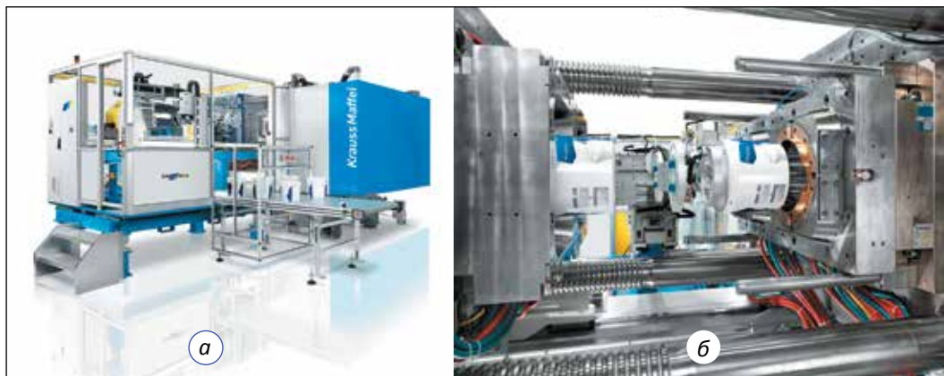
Рис. 2. На выставке «К-2019» на машине GX 1100 (а) в двухгнездной форме будут изготавливаться с временем цикла 14 с этикетированные ведра из ПП емкостью 20 л каждое (б)
