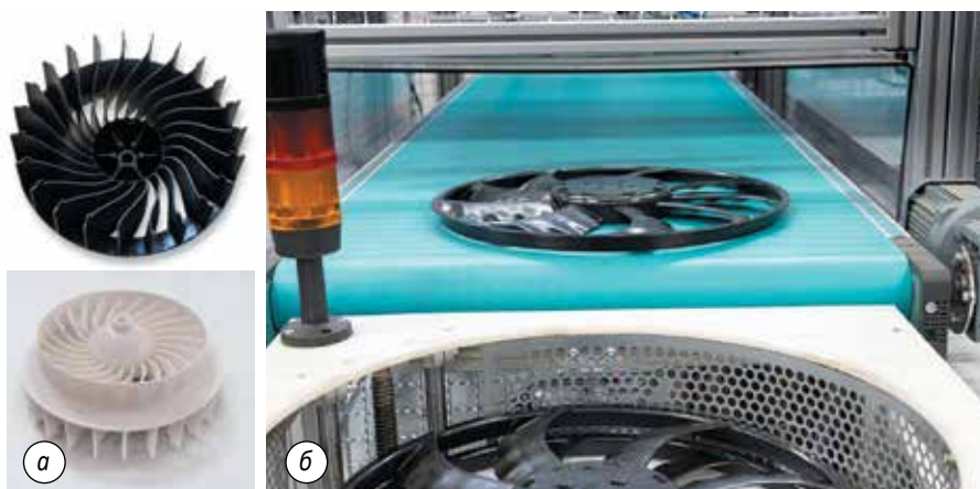
Рис. 1. Примеры крыльчаток осевых вентиляторов, изготавливаемых литьем под давлением (а), и ленточный транспортер для их транспортировки к штабелеру (б) (рис. 1, 3, 4: Wittmann Battenfeld)
