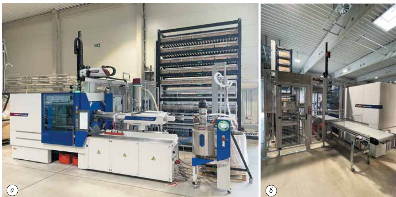
Рис. 2. Вид с фронтальной (а) и обратной (б) стороны на производственную ячейку на основе литьевой машины SmartPower 240/1330 с системой автоматизации группы WITTMANN (источник: Schauenburg )
