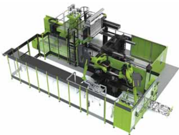
Рис. 2. Первым объектом, оснащенным новым защитным ограждением, стала производственная ячейка для изготовления изделий из полимерного композита, поставленная и смонтированная компанией ENGEL для производителя автомобильных компонентов
