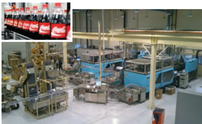
Линии по производству колпачков для бутылок с кока-колой, смонтированные на базе литьевых машин серии El-Exis SP (фото: StackTeck, Coca-Cola Deutschland)
