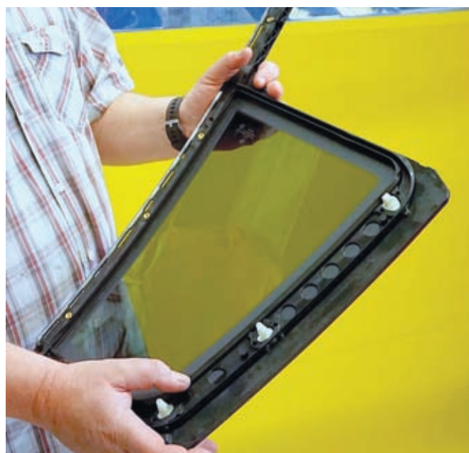
Фото 1. Задний боковой оконный модуль, полностью готовый для дальнейшего монтажа на линии конвейерной сборки автомобилей, состоящий из минерального стекла и закладных деталей (направляющая опускания подвижного оконного стекла и клипсы) и обрешеткой из ТПЭ, нанесенной в процессе литья под давлением (фото 1–6: автор)
