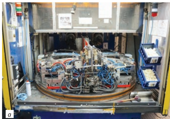
Фото 2. Производственный комплекс на базе вертикальной литьевой машины модели VCRS 2500/SP 2000 b II с поворотным столом, установленный на заводе Henniges Automotive и предназначенный для изготовления задних боковых оконных модулей повышенной сложности
