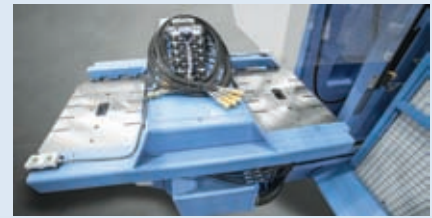
Фото 2. Модуль поворотного стола LWB, комбинируемый с различными узлами смыкания
