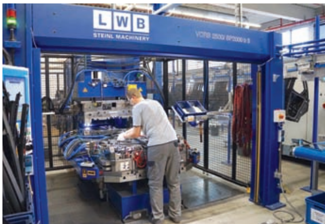
Фото 3. Углубленная в фундамент вертикальная машина LWB в совокупности с другими опциями обеспечивает оператору оптимальный доступ к узлу впрыска и к поворотному столу с формой
