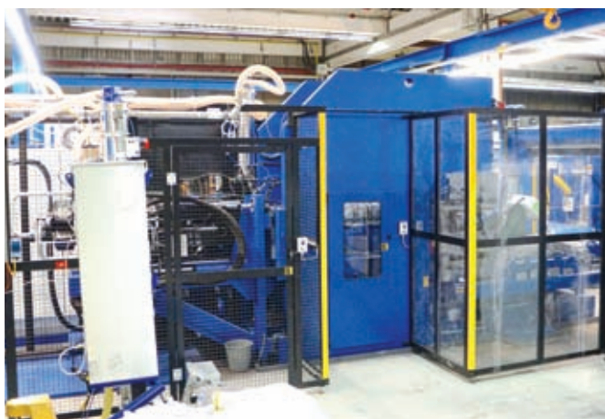
Фото 2. Производственный комплекс на базе вертикальной литьевой машины модели VCRS 2500/SP 2000 b II с поворотным столом, установленный на заводе Henniges Automotive и предназначенный для изготовления задних боковых оконных модулей повышенной сложности
