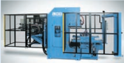
Фото 1. Вертикальная литьевая машина с С-образным узлом смыкания в расширенном исполнении (усилие смыкания создается снизу) (фото 1 и 2: LWB-Steinl)
