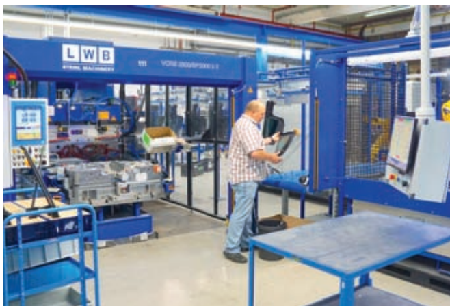
Фото 5. Вид на производственную ячейку на базе вертикальной литьевой машины VCRS 2500/SP 2000 в II (слева). Справа – участок роботизированного нанесения праймера на минеральное стекло в местах его контакта с впрыскиваемым ТПЭ; на переднем плане справа – пульт системы управления ячейкой
