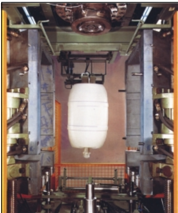
Рис. 3. Узел экструзионно-выдувного формования емкостей объемом от 10 до 3000 л установки серии ВА фирмы «Бекум» (Германия)
