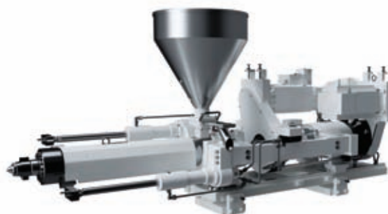
Фото 3. Узел впрыска с двумя параллельными цилиндрами обеспечивает быстрое и симметричное создание требуемого усилия прижатия сопла
