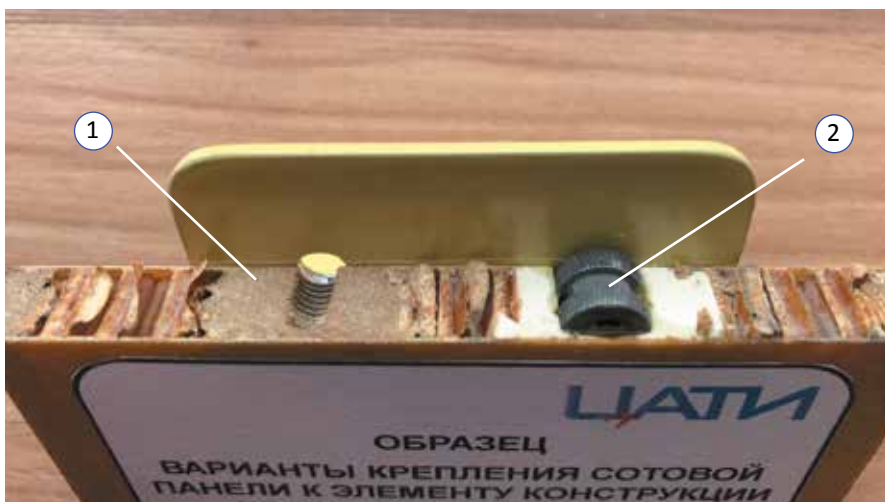
Рис. 5. Варианты крепления сотовой панели к элементу конструкции через полимерную (1) и металлическую (2) втулки
