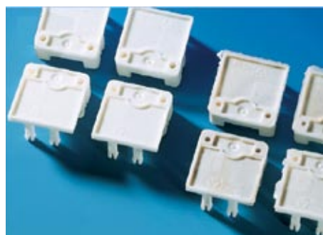
Рис. 9. Качественные литевые детали без следов термической деструкции (слева). Слишком длительное пребывание ПМ в материальном цилиндре приводит к термической деструкции расплава (справа). Кроме того, текучесть расплава из-за термической деструкции настолько увеличивается, что уже не удается избежать переливов в отливках
