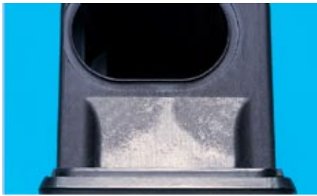
Рис. 11. В корпусной детали из стеклонаполненного ПА видны свили стекловолокна (серая зона) и даже расслоения волокон (светлые зоны) в месте слияния потоков расплава ПМ позади отверстия (холодный спай)
