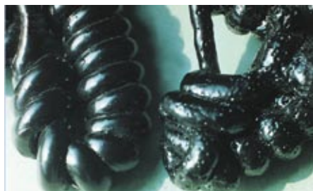
Рис. 4. Жгут из предварительно подсушенного (слева) и недостаточно подсушенного (справа) АБС-пластика со свилями из-за повышенной влажности гранулята
