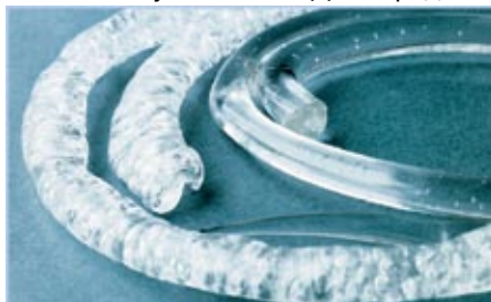
Рис. 3. Жгут ПММА, свободно выдвигнутый из сопла материального цилиндра: внутри – жгут из качественно подсушенного ПММА, который не имеет свиля (внутри жгута – вакуоли, которые образовались из-за охлаждения жгута без избыточного давления); снаружи – жгут с ярко выраженными свилями из-за повышенного содержания влаги в грануляте ПММА
