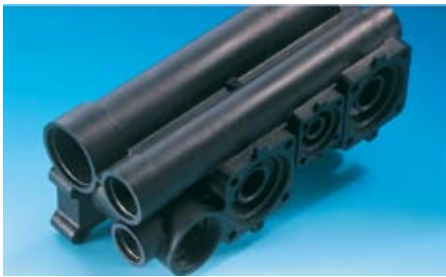
Рис. 10. Корпус клапанов из стеклонаполненного ПА: в районе впускного литника качество поверхности удовлетворительное, но в конце пути потока расплава присутствуют свили стекловолокон
