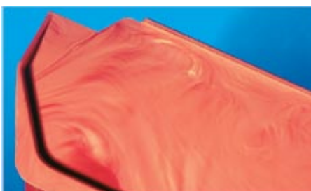
Рис. 5. Свиля в виде светлых полос на поверхности литевой детали из АБС-пластика из-за неравномерного смешивания красителя с основным ПМ при слишком низкой температуре материального цилиндра
