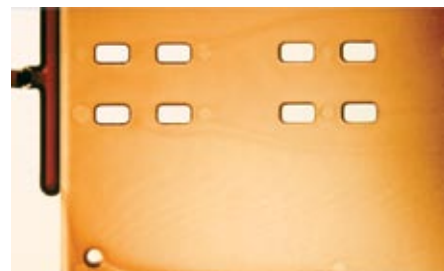
Рис. 6. Неравномерное распределение цвета по поверхности литевой детали из ПММА из-за неравномерного смешивания красителя с основным ПМ при слишком малом времени пребывания смеси в материальном цилиндре
