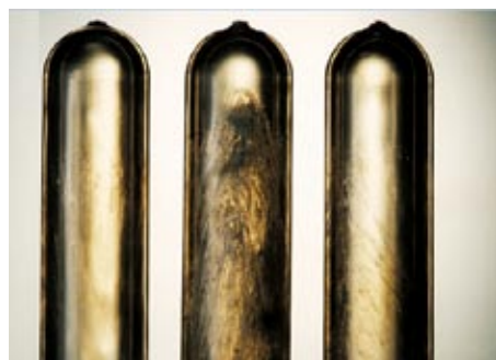
Рис. 8. Свиля на середине пути течения расплава ПЭТ в литевой форме для изготовления преформ для бутылок появились в результате нарушения температурного режима в распределителе горячего канала: впрыснутый сначала расплав был в горячем канале и не имеет пригаров, следующая порция расплава, имеющая пригары, находилась в распределителе горячего канала, и, наконец, последняя порция опять не имеет пригаров
