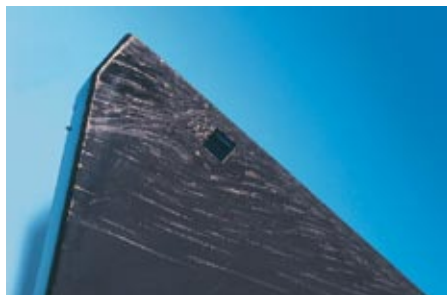
Рис. 1. Характерные свиля на поверхности литевой детали из АБС-пластика из-за повышенного содержания влаги
