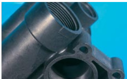
Рис. 12. Ясно различимые стекловолоконные свили в месте слияния потоков расплава ПМ
