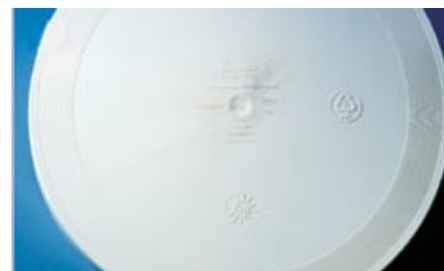
Рис. 7. Литевая деталь из ПП с обугленными свилями в районе впускного литника, возникшими из-за термической деструкции расплава в горячем канале
