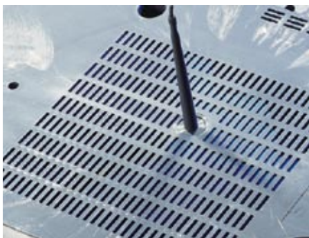
Рис. 2. Свиля в корпусной детали из АБС-пластика, вызванные наличием влаги в расплаве, появились в тех местах, где при заполнении литевой-формы степень сжатия расплава уменьшилась, то есть непосредственно позади отверстий с малой площадью сечения
