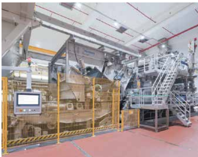
Рис. 3. Внешний вид поточной линии типа WLS: справа – гидроформер фирмы Voith (с помощью таких устройств формируется волокнистый холст в бумагоделательной технологии производства НМ), в центре – струйная установка Trützschler (источник: www.inda.org )
