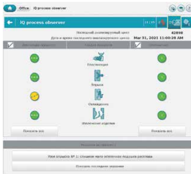
Рис. 1. Обзорная экранная страница iQ process observer представляет информацию о текущем состоянии основных стадий процесса литья в терминах «в порядке» (зеленый свет «светофора») или «не в порядке» (желтый цвет) (все рисунки: ENGEL)
