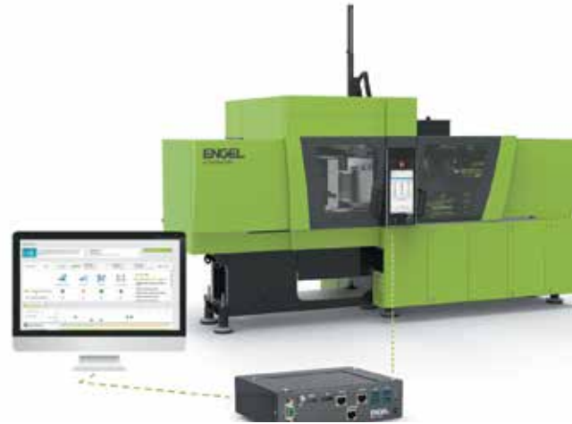
Рис. 4. Аппаратное оснащение iQ process observer, хотя и связано с системой управления литейной машиной, функционирует за ее пределами. При этом внешний компьютер может предоставлять системе iQ process observer данные о веб-приложениях, открывая тем самым ей двери в окружающий «цифровой» мир
