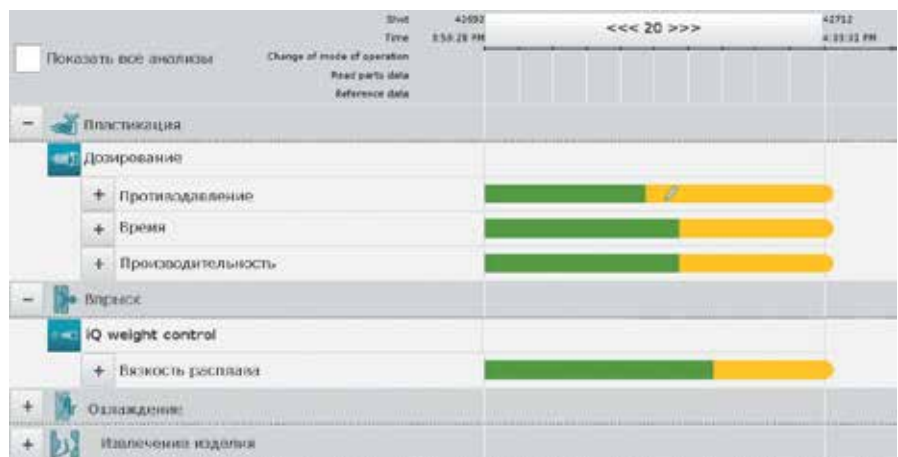
Рис. 2. Пример предоставления информации об изменениях в процессе литья за последние 20 циклов, откуда специалист сразу поймет, что изменения ряда параметров (выделены желтым цветом) являются следствием выполненного пользователем изменения заданного значения противодавления, отмеченного символом в виде карандаша на желтом фоне
